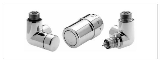
Терморегулирующий комплект X-tra™ специально разработан для дизайн-радиаторов и полотенцесушителей. Он состоит из клапана терморегулятора, термостатического элемента и запорного клапана с дренажной функцией. Инновационное самоуплотняющееся присоединение клапанов к радиатору осуществляется с помощью резьбы ½″.
