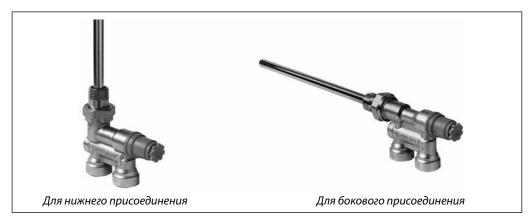
RA 15/6ТВ — гарнитура со встроенным клапаном терморегулятора, предназначенная для «одноместного» присоединения радиатора (через одну пробку) к трубопроводам при их подпольной прокладке в двухтрубной системе отопления.
