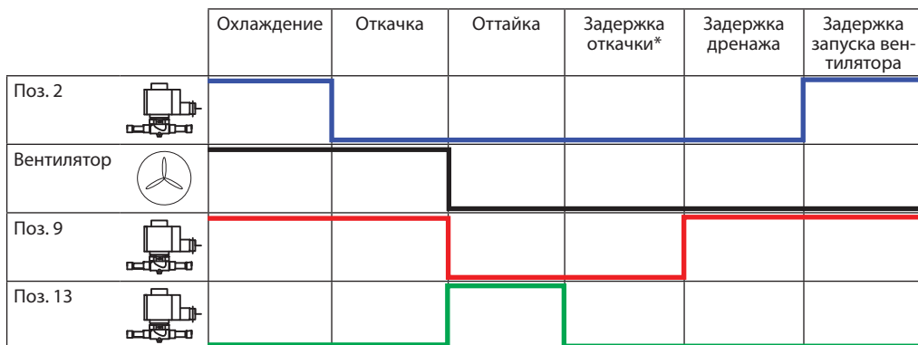
Рис. 2 Циклограмма процесса оттайки.
