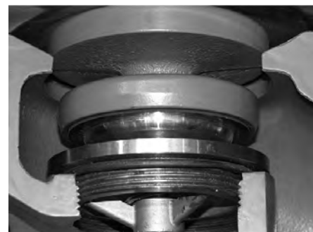
Профилированное седло и затвор из нержавеющей стали
