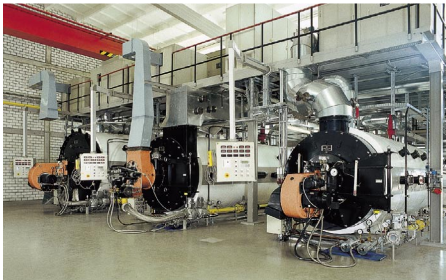
Лаборатория в немецком городе Пирна для испытания горелок большой мощности.
