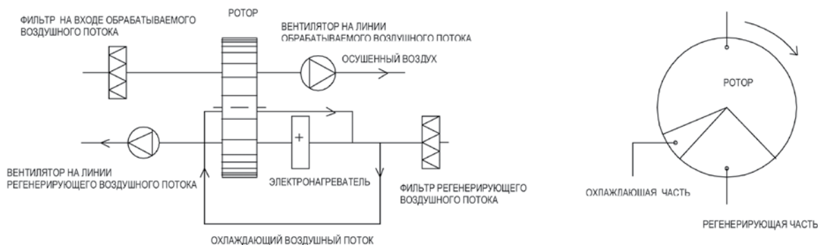
Принципиальная схема осушителей CR1500 – CR2500
