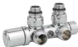
Присоединительный узел для однотрубной/двухтрубной системы с байпасом и запорной функцией, угловое исполнение для присоединения медной или пластиковой трубы, межосевое расстояние 50 мм.
