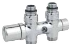
Присоединительный узел для однотрубной/двухтрубной системы с байпасом и запорной функцией, прямое исполнение для присоединения медной или пластиковой трубы, межосевое расстояние 50 мм.
