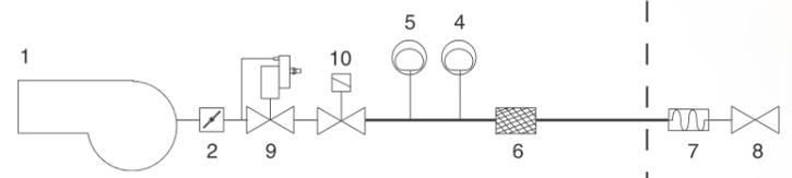
Газовая рампa с группой клапанов VGD со встроенным стабилизатором давления газа + блок контроля герметичности VPS504.
