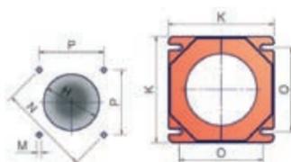
Размеры отверстия плиты котла под горелку
