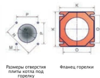
Размеры отверстия плиты котла под горелку
