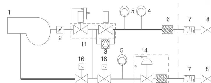
Газовая рампa с группой клапанов VGD со встроенным стабилизатором давления газа + блок контроля герметичности LDU11. Рампа запальной горелки с двойным клапаном и стабилизатором давления газа с фильтром.
