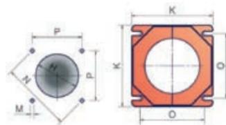
Размеры отверстия плиты котла под горелку
