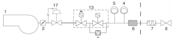
Газовая рампa с группой клапанов DMVDLE + блок контроля герметичности LDU11.
