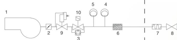
Газовая рампa с предохранительным клапаном + газовый клапан со встроенным стабилизатором давления газа.
