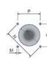
Размеры отверстия плиты котла под горелку
