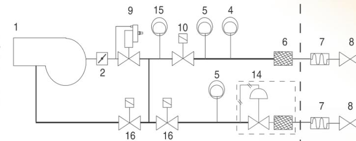
Газовая рампa с предохранительным клапаном + газовый клапан со встроенным стабилизатором давления газа + блок контроля герметичности VPS504. Рампа запальной горелки с двойным клапаном и стабилизатором давления газа с фильтром.
