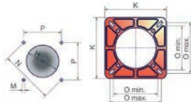
Размеры отверстия плиты котла под горелку
