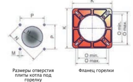
Размеры отверстия плиты котла под горелку
