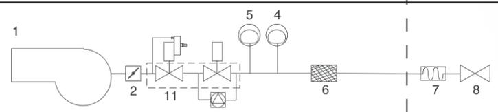
Газовая рампa с группой клапанов VGD со встроенным стабилизатором давления газа + блок контроля герметичности LDU11.
