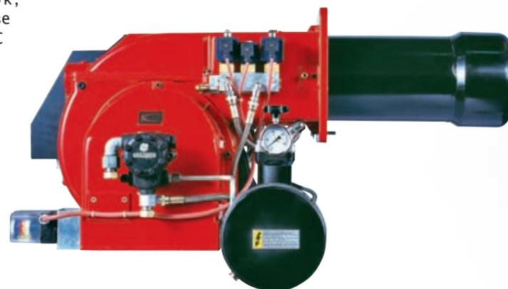
Все горелки имеют прогрессивное регулирование, укомплектованы электрощитами, группой мазутного насоса с двигателем, которая должна монтироваться отдельно со стороны потребителя, а также на них предусмотрена автоматическая очистка форсунки в конце цикла. В связи с этим, рядом должна иметься в наличии компрессорная или паровая установка, обеспечивающая сжатый воздух или пар под давлением 8 бар. На горелках предусмотрен розжиг с помощью запальной горелки, работающей на природном или сжиженном газе.
