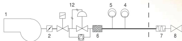
Газовая рампa с предохранительным клапаном + газовый клапан со встроенным стабилизатором давления газа + блок контроля герметичности VPS504.
