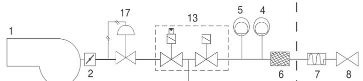
Газовая рампa с предохранительным клапаном + газовый клапан со встроенным стабилизатором давления газа + байпасный клапан + блок контроля герметичности LDU11.
