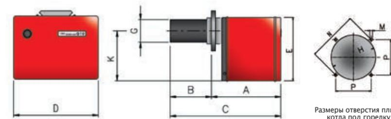
Размеры отверстия плиты котла под горелку
