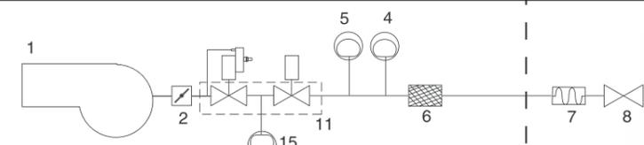
Газовая рампa с группой клапанов DMVDLE + блок контроля герметичности VPS504.
