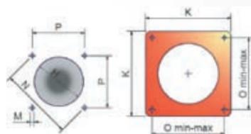
Размеры отверстия плиты котла под горелку
