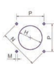
Размеры отверстия плиты котла под горелку
