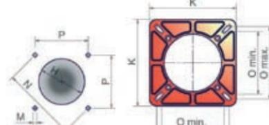
Размеры отверстия плиты котла под горелку
