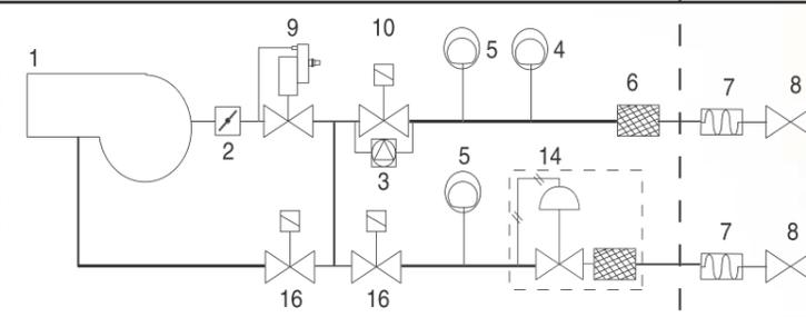
Газовая рампa с группой клапанов VGD со встроенным стабилизатором давления газа + блок контроля герметичности VPS504. Рампа запальной горелки с двойным клапаном и стабилизатором давления газа с фильтром.
