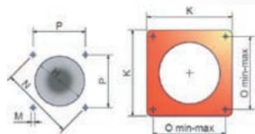
Размеры отверстия плиты котла под горелку
