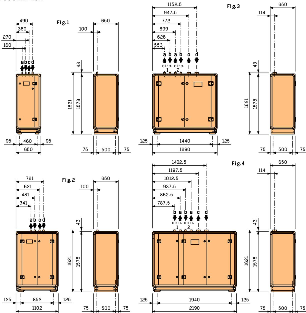
a : Raccordement tuyauterie(s) refluxement
