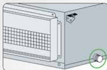
Правое дренажное отверстие
