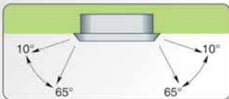
Предотвращение загрязнения потолка
