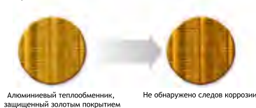
Алюминиевый теплообменник, защищенный золотым покрытием
