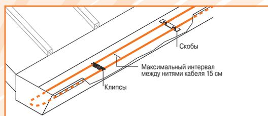
Рис.3.14. Укладка кабеля в желобе в две нити
