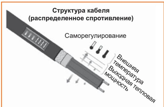
Рис.2.5. Принцип работы саморегулирующегося кабеля
