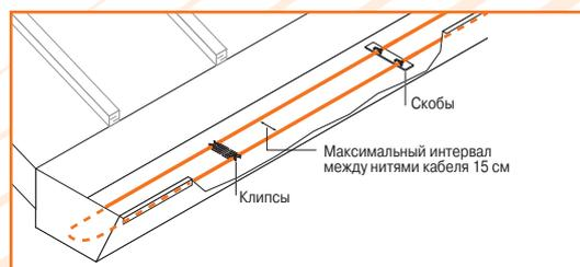
Рисунок 4.9. Схема крепления нагревательного кабеля в широком желобе
