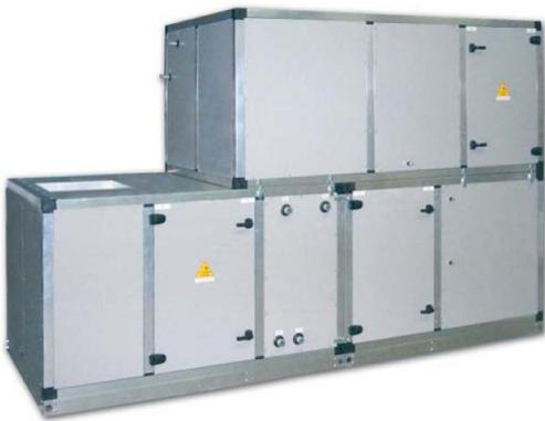
Приточно-вытяжные установки являются сердцем вентиляционной системы, обеспечивая подачу свежего, предварительно очищенного и подогретого (или охлажденного) воздуха в помещение. Агрегаты **HCBIG** могут комплектоваться водяными теплообменниками (включая перекрестноточные) и секциями газового нагрева, секциями осушения и очистки воздуха. Модульный принцип конструкции позволяет интегрировать установки в любые вентиляционные структуры.
