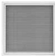
Решетки с сеткой, с квадратной ячейкой размером 13x13 мм, наклонные под углом 45°, со съёмной средней частью, габаритные размеры 595x595мм, с фильтром.
