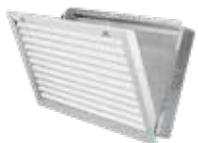
Вытяжная решетка с фиксированными ламелями под углом 45°, с шагом ламелей 25 мм, с откидной контррамкой для установки и замены фильтра. Анодированный алюминий.
