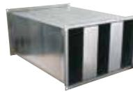
Шумоглушитель прямоугольной формы. Панели шумоглушения 200 мм. Воздушные каналы между панеля 150 мм.
