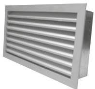
Вытяжная решетка с фиксированными ламелями под углом 45°, с шагом ламелей 25 мм, со съёмной контррамкой для установки и замены фильтра. Анодированный алюминий.
