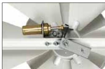
Термостатический привод определяет температуру и автоматически регулирует угол наклона ламелей. Рабочая температура от +15 °C до +30 °C. Никакого дополнительного источника питания или электрического монтажа не требуется.
