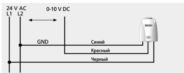
Рис.51. Схема подключения привода
