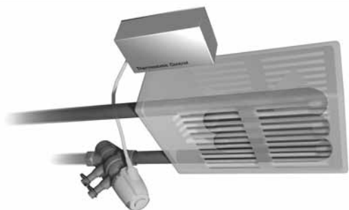
Рис.30. Установка клапана БРОЕН Dynamic с электроприводом на обвязке фанкойла.
