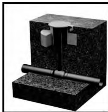
Подземный кран, установка под ковер
