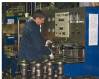
Тестирование шаровых кранов
