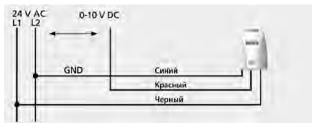
Рис.3.20. Схема подключения привода
