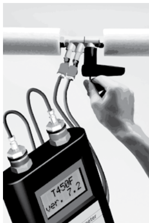
Рис.1.4. Измерение расхода на клапане BALLOREX® Venturi
