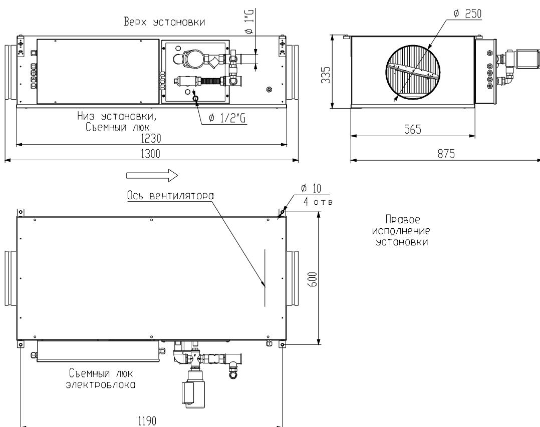
Приточная установка может выполняться в Правом (как на чертежах) и Левом исполнении. Если смотреть со стороны входа ПУ, то при Левом исполнении блок автоматики и выходы калорифера / смесительный узел будут расположены с левой стороны ПУ.
