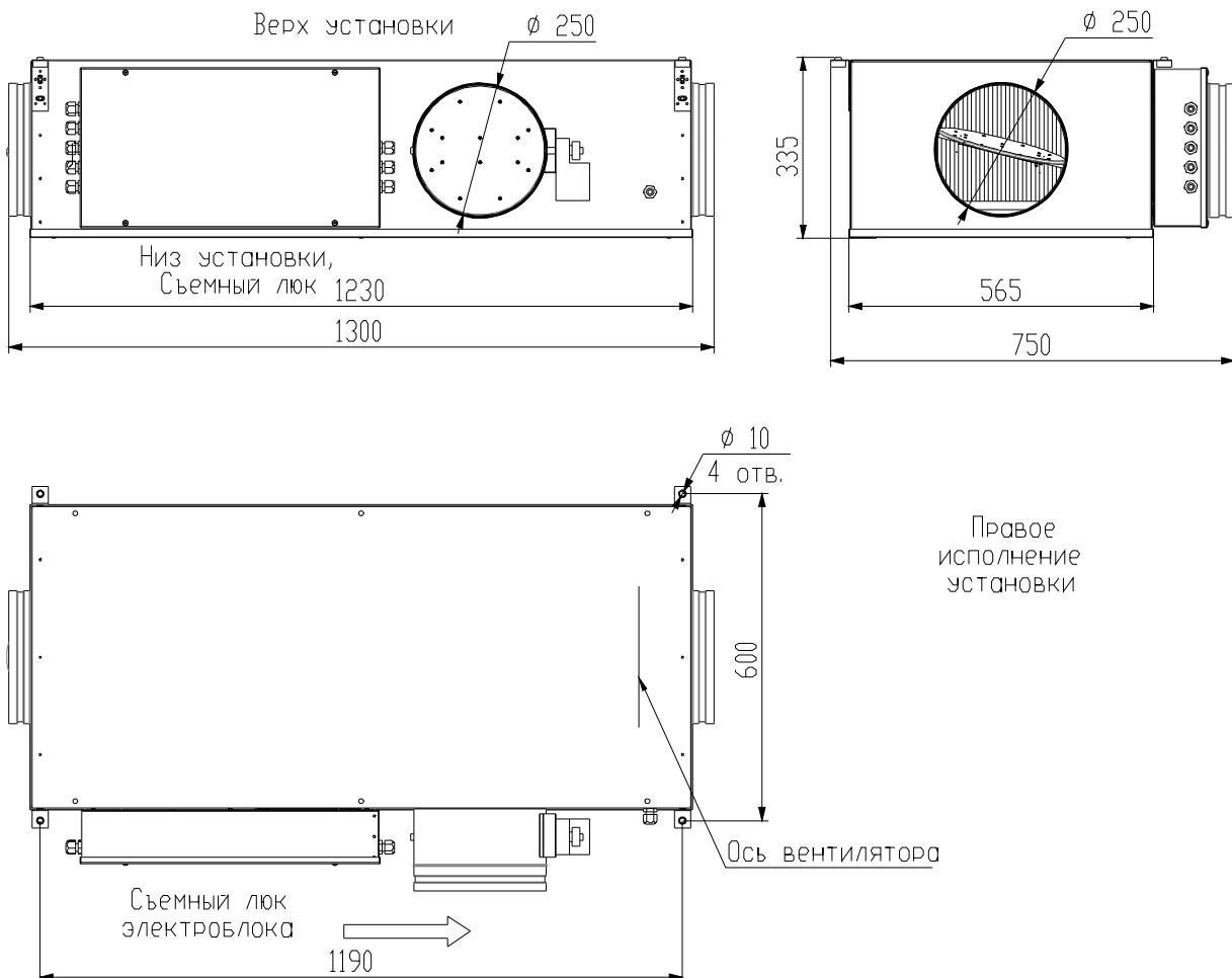
Приточная установка может выполнять в Правом (как на чертеже) и Левом исполнении. Если смотреть со стороны входа ПУ, то при Левом исполнении блок автоматики и вход рециркуляционного канала будут расположены с левой стороны ПУ.
