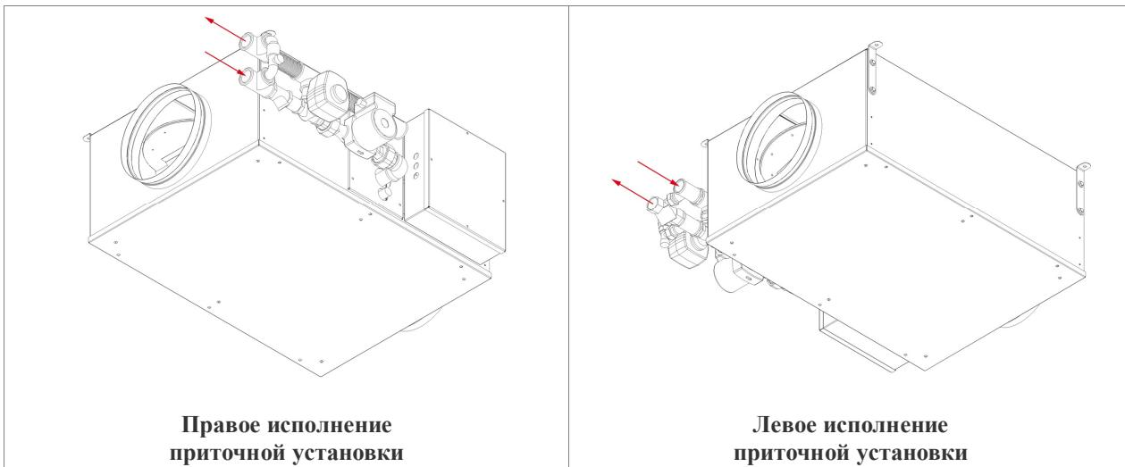
Приточная установка с водяным калорифером может быть выполнена в **Правом** или **Левом** исполнении, в зависимости от расположения смесительного узла и блока автоматики. Если на приточную установку, находящуюся в рабочем положении, смотреть со стороны входа (там, где расположен воздушный клапан), то:
