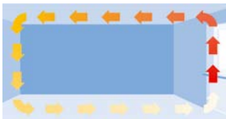
Распределение тепла при радиаторном отоплении
