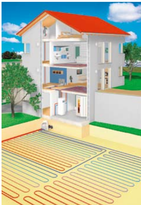
Монтаж коллектора теплового насоса типа «грунт – вода» (горизонтальный коллектор)
