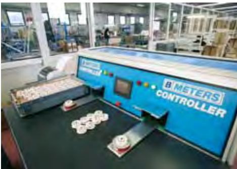
Controllo sensibilità orologeria Test benches for mechanisms' sensibility
