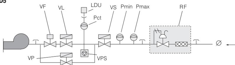
Горелки без блока контроля герметичности копанов
