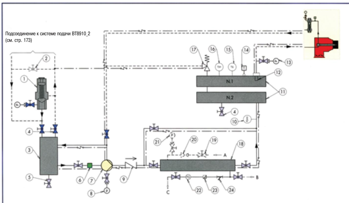
**Примечание:** система подачи топлива от резервуара до горелки является закрытой системой с дополнительным насосом, условия работы 0,5-3 бара при 60°C.
