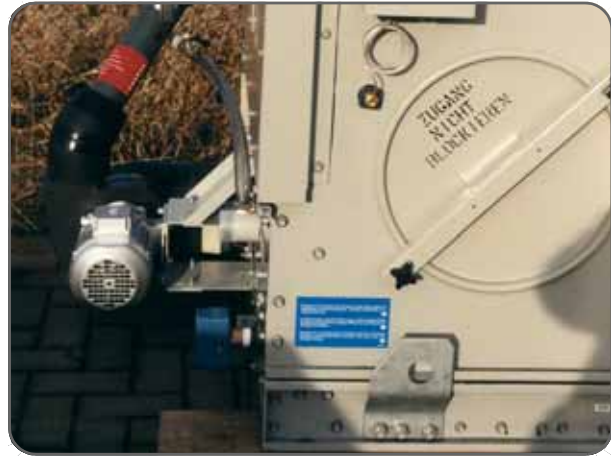
Перемещение насоса оросителя в изделии VL
