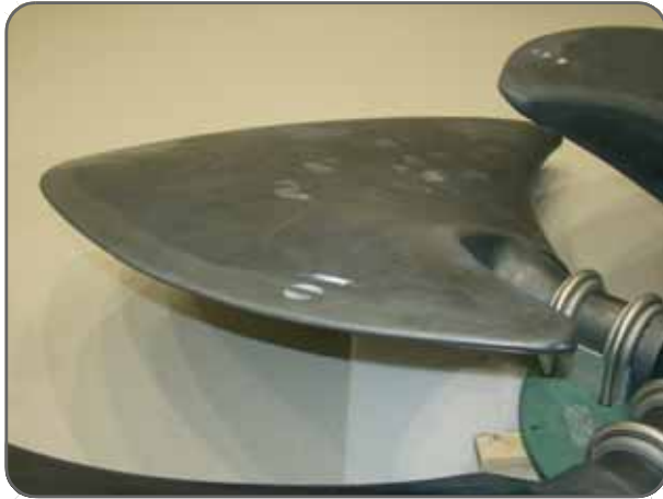
Конструкция лопасти со специальным аэродинамическим профилем
