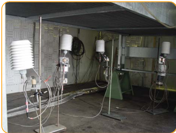
Измерение производительности сухих градирен DFC
