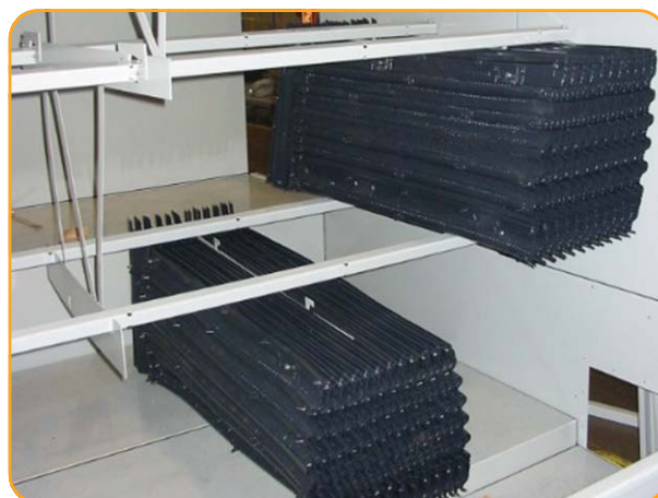
Легко снимаемые пакеты наполнителя
