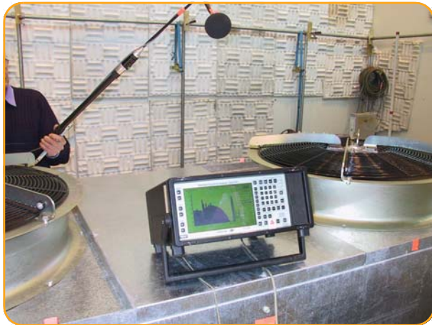
Акустическая проверка сухой градирни DFC
