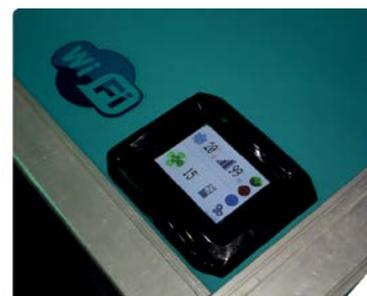
Возможность диспетчеризации по протоколу Modbus или Ethernet. Управление при помощи проводного пульта дистанционного управления либо посредством Wi-Fi.
