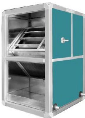
Обмен тепла происходит без промежуточного теплоносителя. Приточный и вытяжной воздух проходят через рекуператор и обмениваются теплом. Холодный воздух нагревается, теплый охлаждается.
