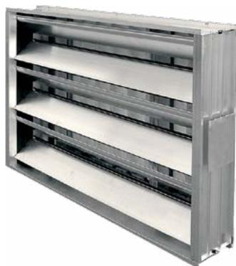
Клапан состоит из корпуса, алюминиевых полых створок жалюзи с ребрами жесткости и зубчатой передачи. Особенность конструкции заключается в изолировании шестерней от потока воздуха, что исключает попадание в них грязи и обеспечивает большой ресурс и надежную работу передачи.
