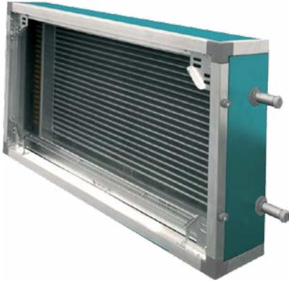
Теплообменники выполняются в виде медного змеевика с алюминиевым оребрением. Для увеличения теплоотдачи трубы механически расширены и тем самым жестко соединены с оребрением.
