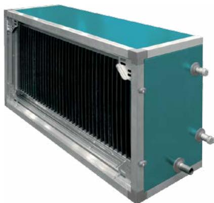
Теплообменники охлаждения предназначены для понижения температуры воздуха, но так же могут использоваться для осушения воздуха. В случае осушения необходимо доукомплектовать установки вторым, догревающим теплообменником.
