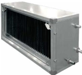
Водяные охладители традиционно выполняются в виде медного змеевика с алюминиевым оребрением. Для увеличения эффективности трубы механически расширены и тем самым жестко соединены с оребрением.
