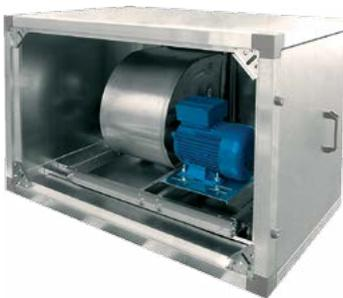
Для конструирования вентиляционного агрегата применяются радиальные вентиляторы с вперед или назад загнутыми лопатками. Вентилятор состоит из рабочего колеса, корпуса, опорной рамы и электрического двигателя.
