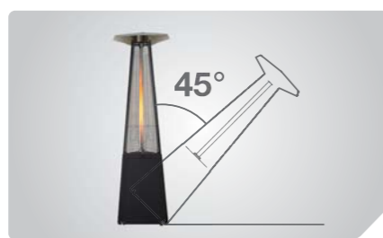
Автоматическое отключение при падении
