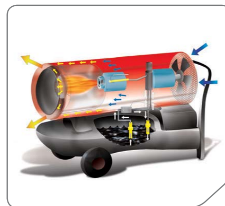
Принципиальная схема работы нагревателя серии GE
