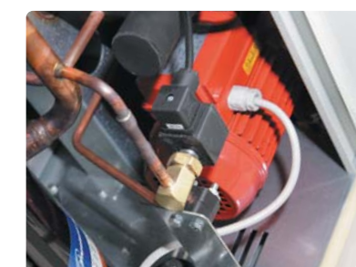
Встроенная насосная станция
