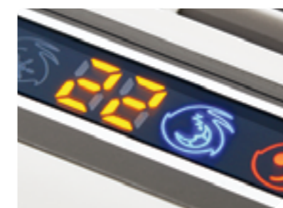
LED-дисплей с индикатором температуры и режимов работы.
