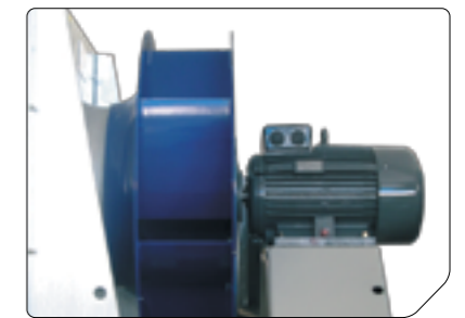
Вентиляторное колесо и двигатель Ziehl-Abegg (Германия)
