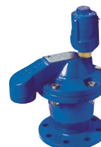
Серия 701/50 Клапан воздушный комбинированный Фланцевый DN50-300 PN16 Серый чугун/ Армированный полиамид
