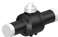
Серия 85/30 Шаровый кран с патрубками DN25/Ø20 мм - DN150/Ø180 мм PN10 ПЭ100
