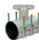
Series 748/02 Ремонтный хомут двухленточный Нерж. сталь AISI 304 или AISI 316 NBR или EPDM По запросу: • С пластиной
