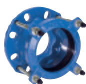
Серия 603 Фланцевый адаптер Supra® универсальный для труб из НПВХ, АЦ, стали, литейного и высокопрочного чугуна. Универсальная рассверловка Высокопрочный чугун DN 40-400 PN 10/16
