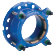
Серия 623/10 Фланцевый адаптер Supra Plus™ Фиксирующий для ПЭ и НПВХ труб. Универсальная рассверловка Высокопрочный чугун DN 40-300 PN 10/16
