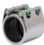
Серия 745/20 Соединитель Repico® Универсальный и нефиксирующий для всех типов труб Нерж. сталь AISI 316 NBR или EPDM DN15-600
