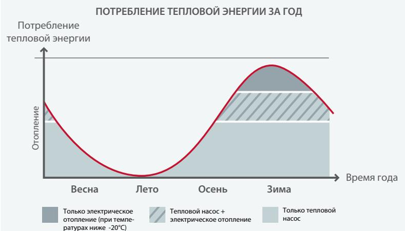
Более 70% годовой потребности в тепловой энергии покрывается за счет теплового насоса с возобновляемым и неисчерпаемым источником энергии - воздухом.
