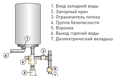
СХЕМА ПОДКЛЮЧЕНИЯ ДЛЯ НАСТЕННЫХ ВЕРТИКАЛЬНЫХ МОДЕЛЕЙ
