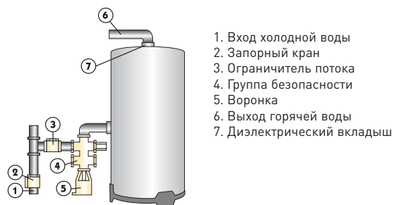
СХЕМА ПОДКЛЮЧЕНИЯ ДЛЯ НАПОЛЬНЫХ МОДЕЛЕЙ
