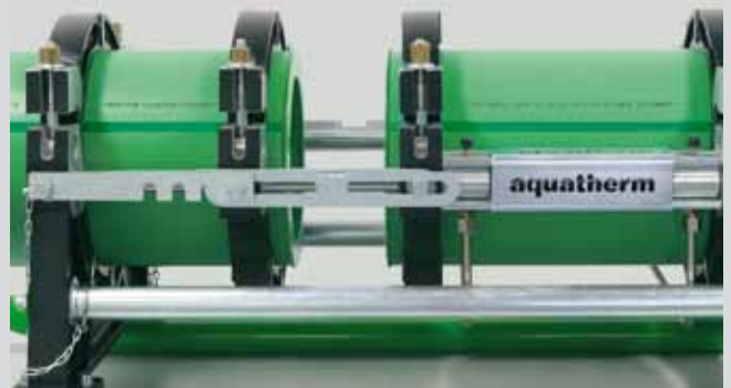
Трубы развести, удалить нагревательный элемент
