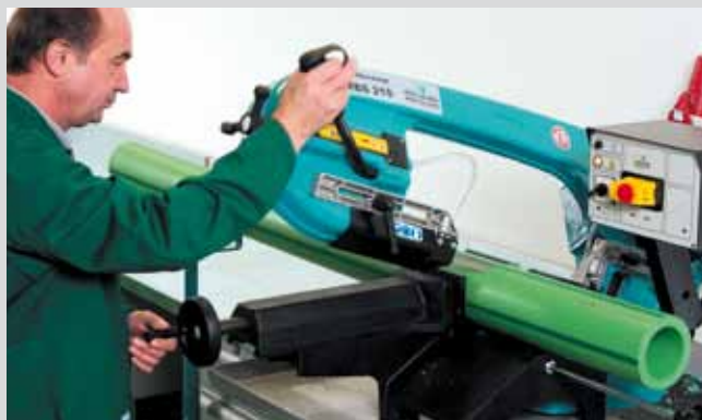
Перед сваркой отрезать трубу на необходимую длину
