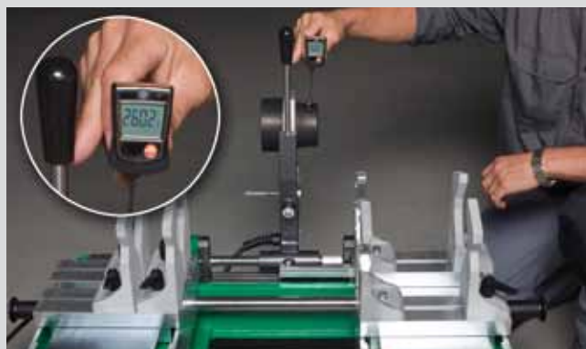
Измерение температуры на сварочной машине aquatherm
