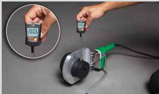
Измерение температуры на ручном сварочном аппарате aquatherm (1400 Вт)
