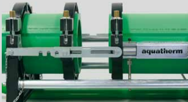
Свариваемые части вставить, выровнять и зафиксировать
