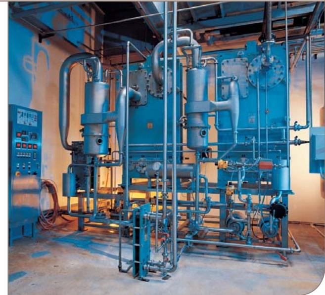
в системе. Однако в отличие от других испарителей на основе этой же технологии практически все процессы испарения в системе AlfaVap протекают в пределах кассет. Последние, таким образом, выполняют роль заполняемых пеной отсеков кипячения, где скорость движения испаряющейся среды очень велика.
