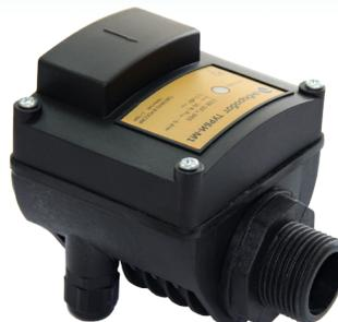
**Блок автоматики «ТУРБИ-М»** предназначен для автоматического управления по потоку однофазными насосами мощностью до 1,5 кВт и силой тока до 16 А.
