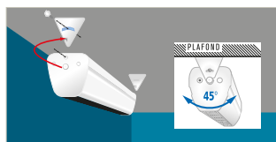
Pose et réglage au plafond
