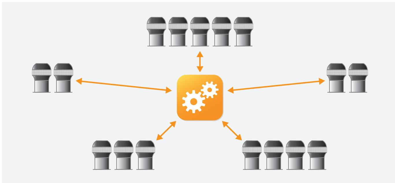
С помощью системы управления можно подключить группу вентиляторов VBP+, которые в зависимости от температуры воздуха будут изменять скорость своей работы. Мощность вентиляторов настраивается в соответствии с конфигурацией здания (высота вентиляционной шахты, тип соединения каналов и т.д.). Кроме того, в системе присутствует сигнальный выход и индикатор неисправности.
