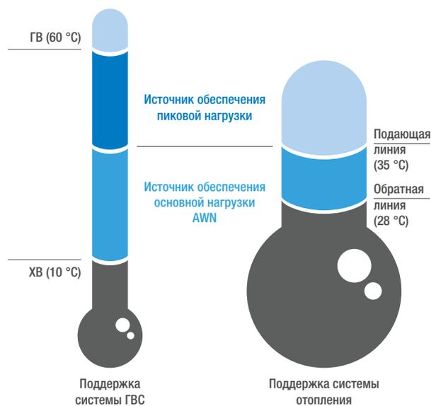
Гидравлическая схема должна быть спроектирована таким образом, чтобы предпочтительным источником обеспечения тепловой нагрузки являлась рекуперативная энергия. Увеличение полезного времени работы достигается, прежде всего, за счет работы с потребителями с пониженными температурами.
