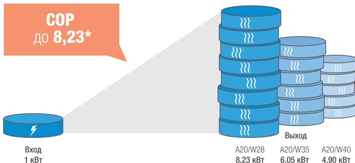
\* Рабочая точка (A20 / W28) Это значение было получено в ILK Дрезден для удаляемого воздуха с температурой 20°C и относительной влажностью 50%. Поскольку удаляемый воздух может иметь более высокие значения, возможны еще более высокие показатели COP.
