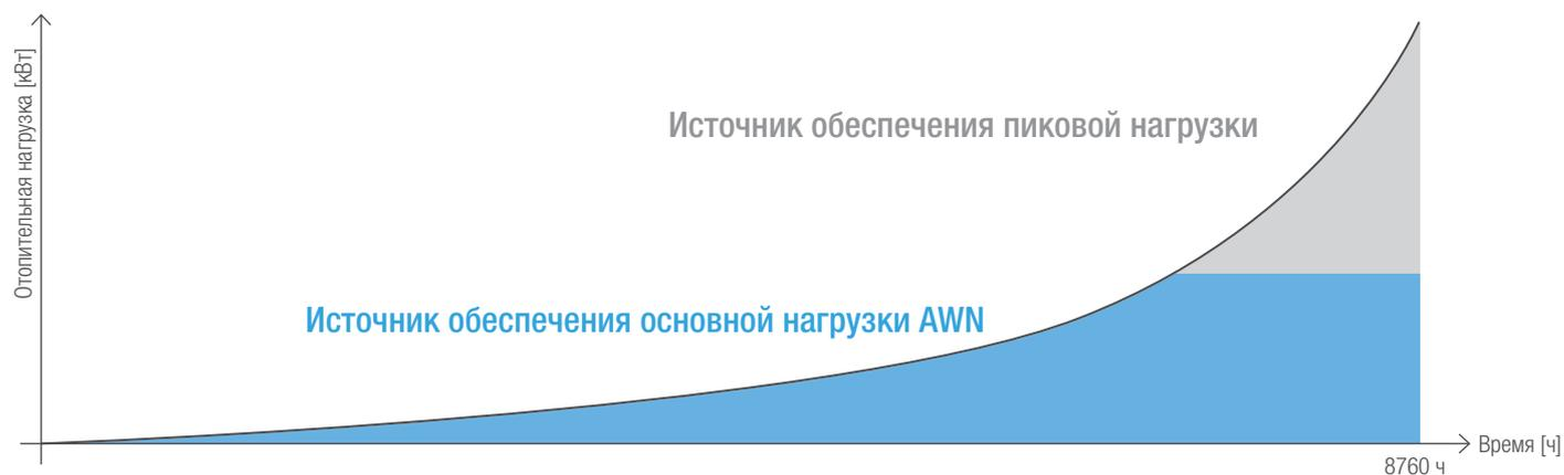
**Тепловой мощности AWN достаточно для покрытия отопительной нагрузки здания в большую часть времени.** При низких наружных температурах и в периоды высокой потребности в горячей воде требуется использование вспомогательного источника теплогенерации.
