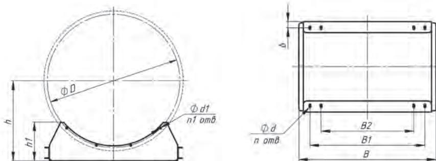
Межосевое расстояние между отверстиями в основании опор вдоль длины корпуса вентилятора  $L$  равно  $L - 5 - 2 * b$ .
