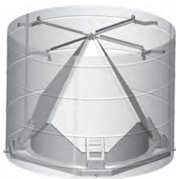
Экраном ЭВ может дополнительно оснащаться клапан выпускной КВК для минимизации ветрового воздействия на заслонки.
