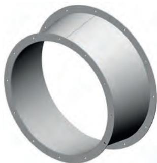
Диффузор ДФ устанавливается на выходе из осевого вентилятора для преобразования части динамического давления в статическое давление при уменьшении скорости потока.
