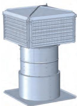
Вентилятор устанавливается вертикально на цилиндрический стакан с фланцем для присоединения к проему крыши и закрывается входным колпаком с жалюзийными боковыми стенками для защиты от попадания атмосферных осадков через вентиляторную установку внутрь здания.
