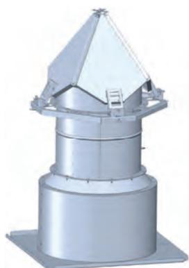
Крышная вытяжная установка состоит из вентилятора с вертикальной ориентацией оси вращения, теплоизолированного стакана и выпускного обратного клапана. Клапан имеет угол наклона створок, препятствующий скоплению на нем снега. При отключении вентилятора он закрывается и защищает здание от попадания атмосферных осадков внутрь через вентиляторную установку. В открытом положении клапан не создает сопротивление.
