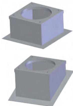
Постамент ПСВ применяется для установки на крыше монтажных стаканов вентиляторов при отсутствии строительной конструкции под установку стакана или вентилятора и для удобства примыкания элементов кровли. Постамент выпускается параллелепипедной формы с теплоизолированными стенками для установки на горизонтальную и скатную крышу. Максимальный уклон  $27,5^\circ$ . Для спаренных установок вентиляторов по запросу поставляется постамент заводского изготовления.
