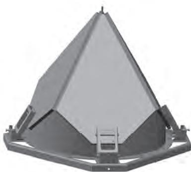
Клапаны выпускные КВК устанавливаются на выпускные патрубки вытяжных вентиляторов с цилиндрическим корпусом при их установке на крыше с вертикальной ориентацией оси вращения. Выпускной клапан обеспечивает выброс потока вверх без потерь статического давления, при этом его самозакрывающиеся заслонки, выполняя функцию обратного клапана, защищают от атмосферных осадков при неработающем вентиляторе. Опционально может оснащаться экраном для защиты заслонок от воздействия сильных порывов ветра.
