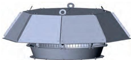
Зонт ЗВК – это воздухозаборное устройство в виде многогранного колпака на стойках, закреплённых на коллекторе для осевого вентилятора. Сечение зонта вдоль периметра стоек огорожено сеткой.
