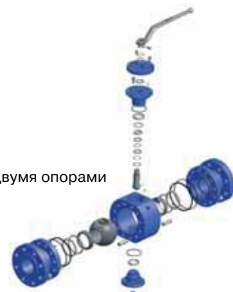
Конструкция крана с двумя опорами шара
