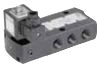
Соленоидные распределительные клапаны ASCO Numatics (серия 551, 552, 553) 3/2, 5/2, 5/3-х ходовые, NAMUR интерфейс
