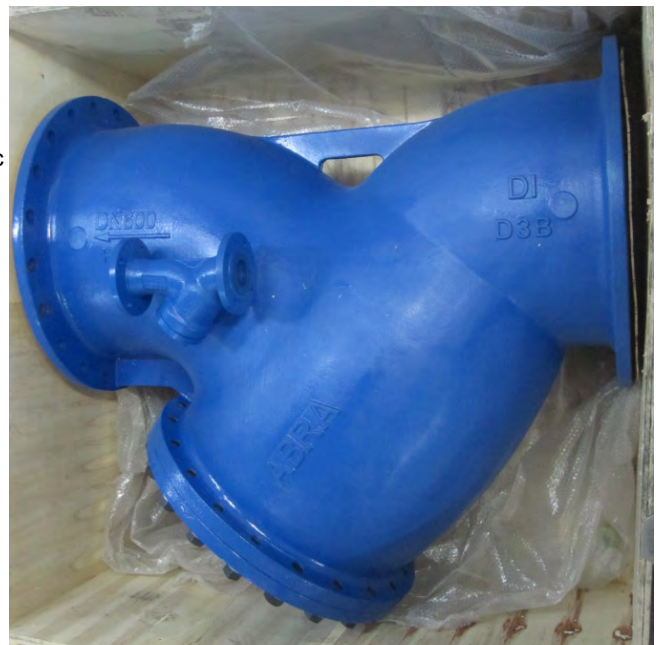
На фото фильтр DN 600, сверху лежит DN 65
