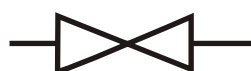
Вариант 2. Знак "Вентиль проходной". Шаровый кран так обозначать неверно, но обозначают так часто.
