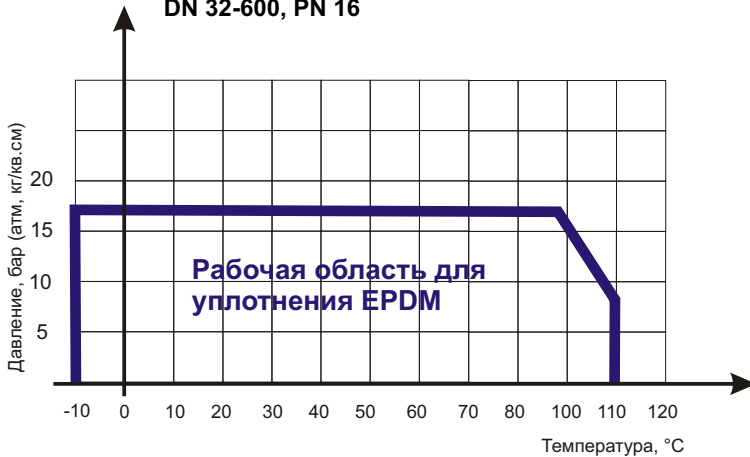
Диаграмма Давление / Температура для затвора поворотного дискового ABRA-BUV-VF826Dxxx и ABRA-BUV-VF866D DN 32-600, PN 16
