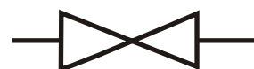
Вариант 2. Знак "Вентиль проходной". Шаровой кран так обозначать неверно, но обозначают так часто.
