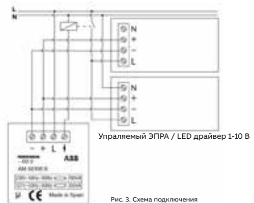
Рис. 3. Схема подключения с использованием контактора.
